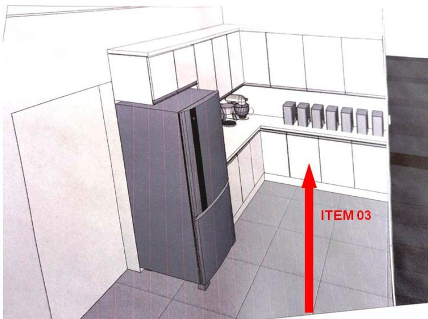
Uma unidade **Balcão inferior** lado refrigerador 2 portas 78 x 75 x 60 com 1 divisória, balcão canto com abertura 165 graus com divisória 97,8 x 75 x 79, balcão 3 portas inferior 130 x 75 x 40, tampo MDF 157 x 36 x 228.
