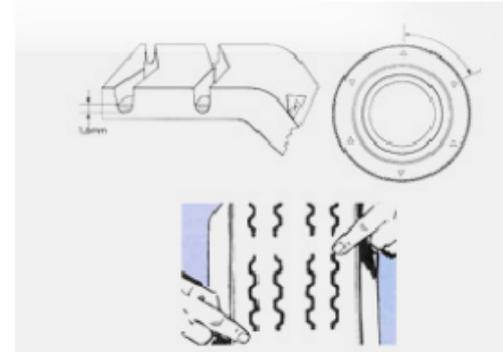
Ou seja, percebe-se claramente que a validade do pneu não é identificada pela sua data de fabricação (DOT), mas sim pelo desgaste do Treadwear, devido ao seu uso. Quanto mais usar o pneu, mais desgaste terá, e vice-versa.
